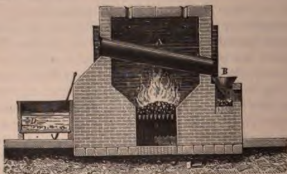
Fig. 259. — Appareil de Schneeberg pour l'extraction du bismuth.
